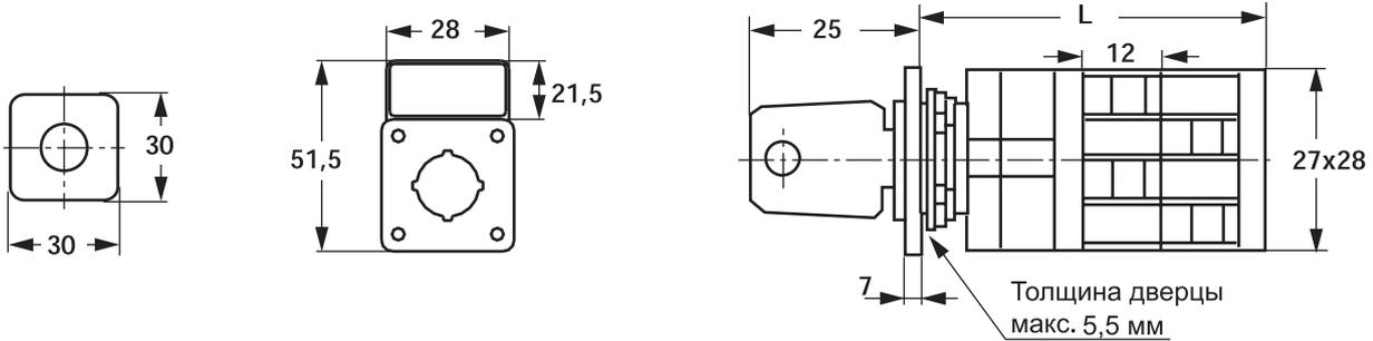
Отверстия в двери для монтажа переключателя:
