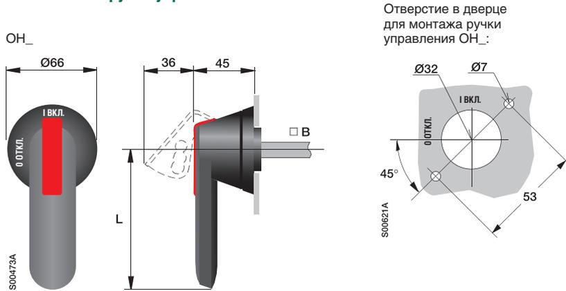
Отверстие в дверце для монтажа ручки управления OH\_:
