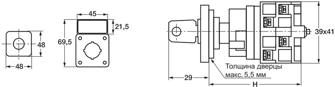
Отверстия в двери для монтажа переключателя:
