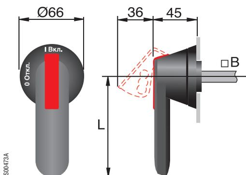
Отверстие в двери шкафа для монтажа выносной ручки управления OH\_
