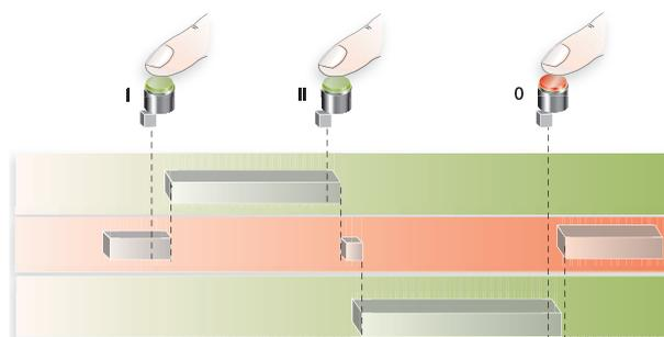
Команда непрерывного управления может быть задана кнопочными переключателями, кулачковыми переключателями или реле, смонтированными в запрограммированный логический контроллер.
