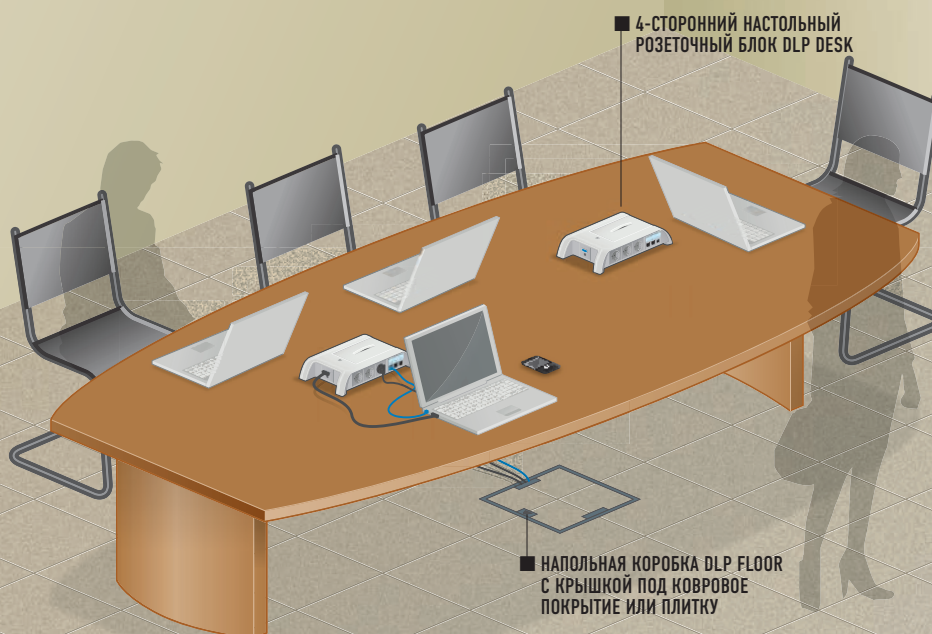
ПОМЕЩЕНИЕ С КАБЕЛЬНЫМИ ТРАССАМИ В ПОЛУ
