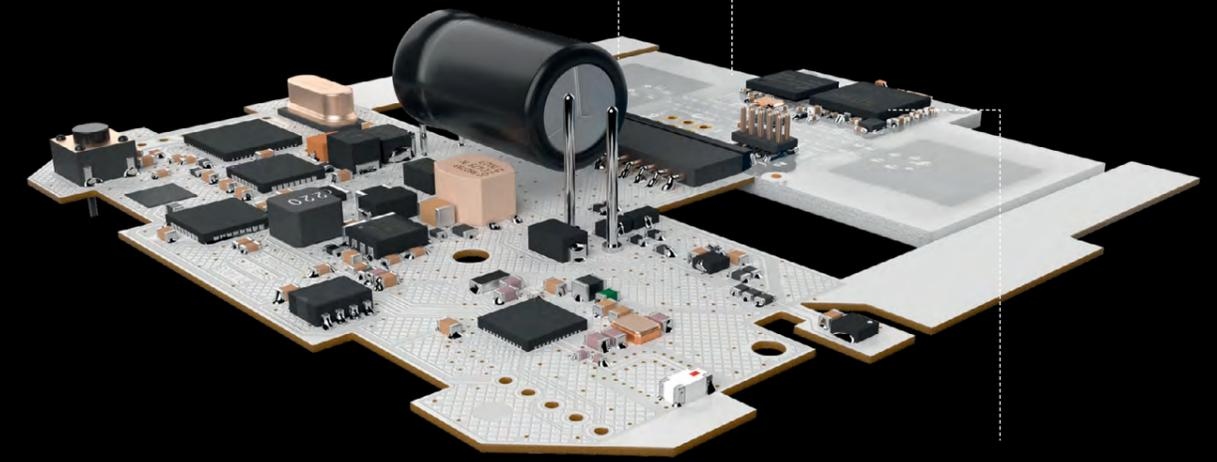
Высокоскоростные процессоры для оценки данных датчика.
